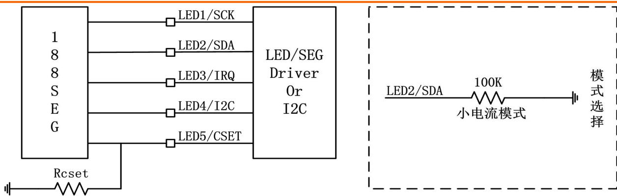
带%及快充指示的快充 188 数码管型号为 KHP302518，通过 LED4/I2C Pin 对地接 100K 电阻设置，结构图及内部连接方式为：
